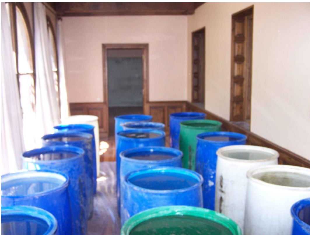
Foto nº 8: Paño 2. Detalle de Escalón III de Carga.
