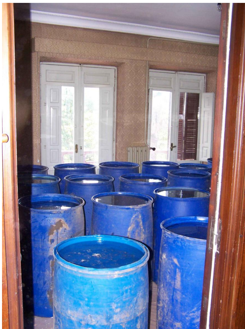
Foto nº 5: Paño 1. Detalle de Carga Completa.
