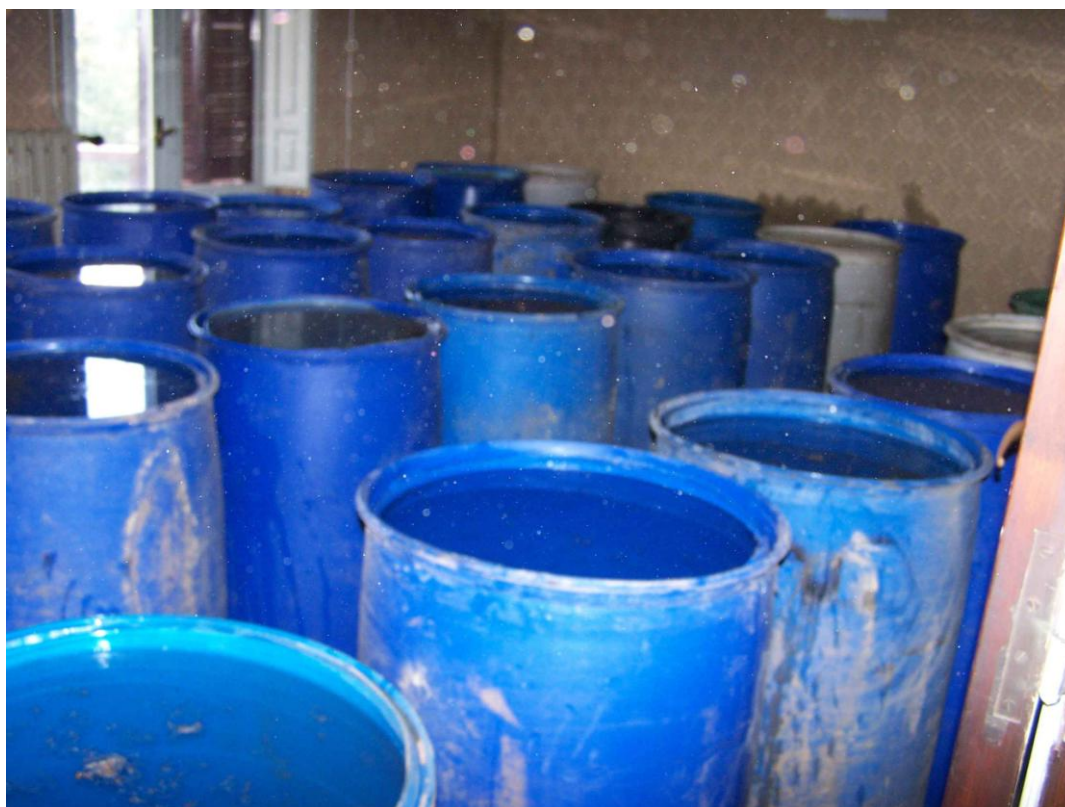
Foto nº 4: Paño 1. Detalle de Carga Completa.
