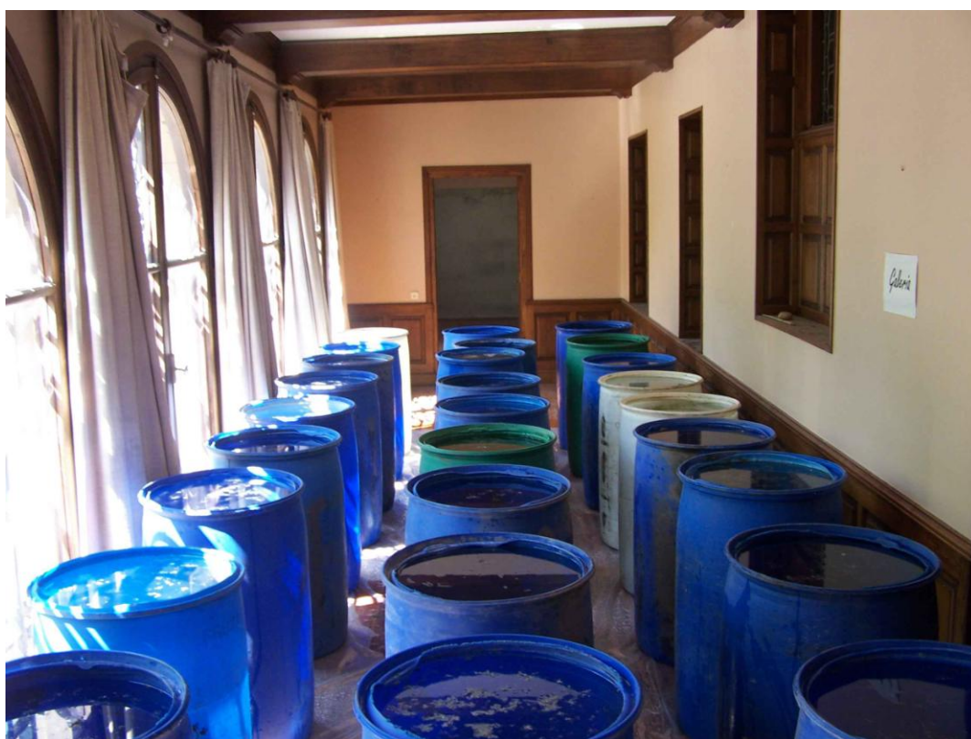
Foto nº 9: Paño 2. Detalle del Escalón V de Carga. Carga Completa
