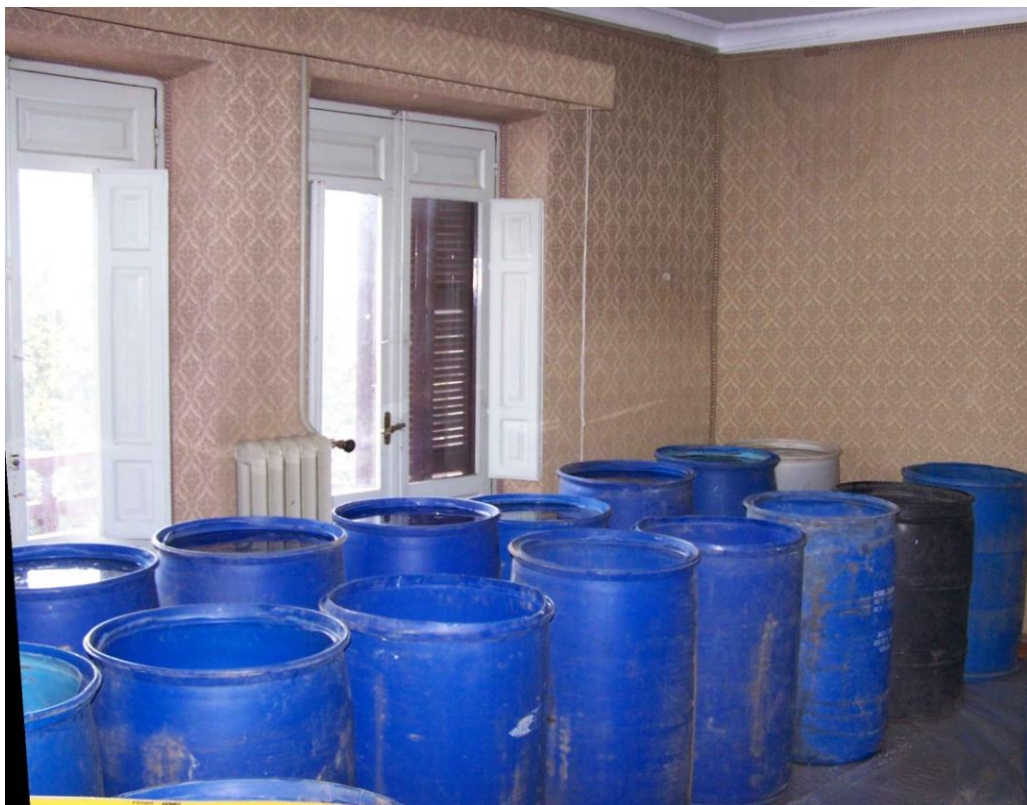
Foto nº 3: Paño 1. Detalle del Escalón I de Carga.
